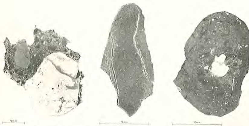
Fig. 8, 9 og 10. Tre tyndsnit af prøver på springere. Til venstre er der foregået skadelige alkalikiselreaktioner i den store lyse sten af kalkopalflint, altså en samvirken mellem skadelige alkalikiselreaktioner og frostpåvirkninger. I midten ses en alkaliaktiv bjergart (porøs kalkopalflint), hvor revnedannelsen antagelig skyldes skadelige alkalikiselreaktioner. Til højre en sten, der ikke er alkalireaktiv (porøs kalksten), men dens højporøse struktur med submikroskopiske porer er et kendetegn på en frostfarlig bjergart, hvorfor springerdannelsen her antagelig må skyldes ekspansion som følge af frostpåvirkninger alene.
