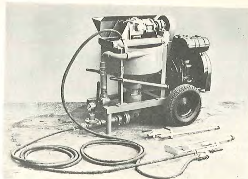
Fig. 81. Da Colcrete-blandemaskinen arbejder diskontinuerligt, medens udstobningen som regel forløber bedst, når der pumpes kontinuerligt, indskyder man gerne en lagerbeholder og en særlig »Monopumpe«, som transporterer mortelen kontinuerligt med et tryk på indtil 8 atm. En sådan pumpe (Colmonopumpe) ses på figuren.
