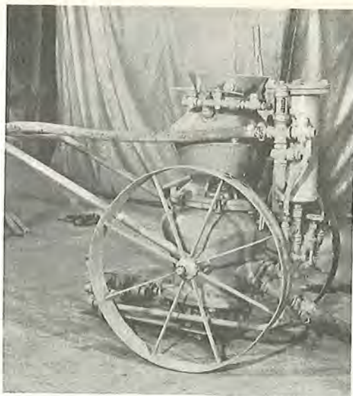
Fig. 41. Cementkanon af sædvanlig konstruktion og størrelse (rumfang 25 l). I cementkanonen er indbygget en vandudskiller, der ses som en lodret cylinder øverst til højre i billedet. Trykluftslangen ses øverst til venstre og materialslangen nederst til højre.
