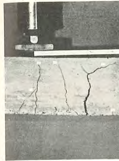
Fig. 34. Trækbrud i jernbetonprøvebjælke.
